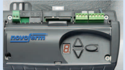
Eenvoudige en snelle elektro-installatie. Van buiten gemakkelijk toegankelijke inklemmingsruimte: comfortabele adapterklemmen voor veilige aansluiting.
